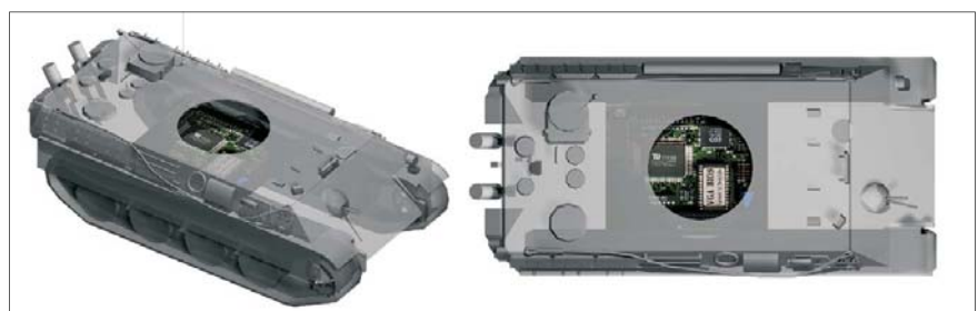
Rys. 3. Wizualizacja rozmieszczenia elementów elektronicznych aparatury pokładowej na platformie jezdnej systemu detekcji i lokalizacji strzału wykonana w programie Autodesk VIZ
