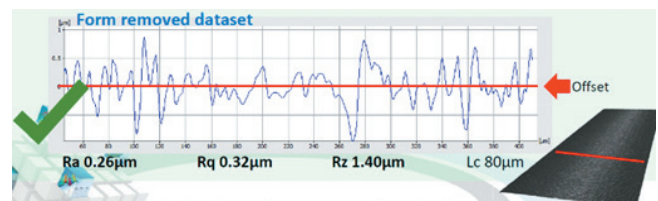
Rys. 5. Wykres profilu chropowatości uzyskany metodą różnicowania ogniskowego
