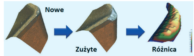
Rys. 8. Porównanie fragmentu narzędzia nowego i zużytego
