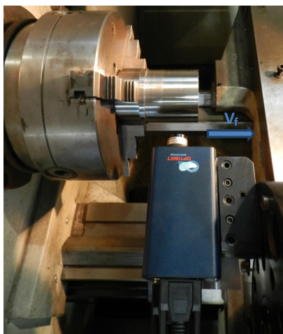
Rys. 4. Pomiar chropowatości trzech stref próbki z zaznaczonym kierunkiem ruchu suportu tokarki
